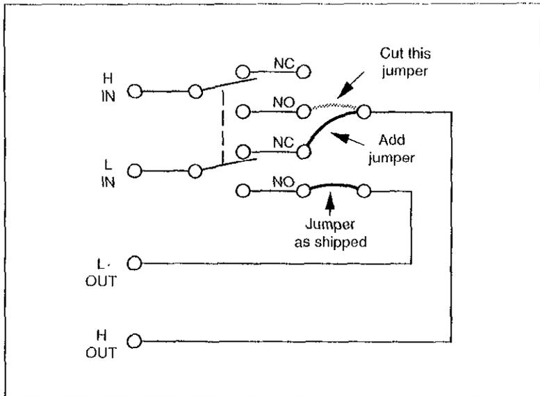
**Figure 2-5. SPDT Configuration**
