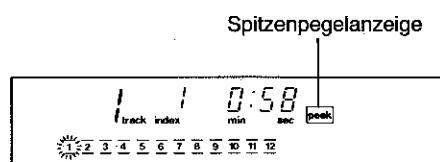
Beim Auffinden des Spitzenpegels erzeugt das Gerät ungefähr 6 Sekunden lang den Ton in der Nähe des Spitzenpegels.
