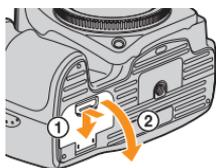
Ouvrez le couvercle de batterie tout en faisant glisser le levier d'ouverture du couvercle de batterie.
