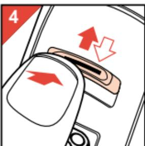
Een beveiliging voorkomt dat het apparaat toevallig wordt ingeschakeld.
