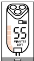
**Medidor de energía.** Los bloques indicarán en cada momento el nivel de energía de las baterías recargables.
