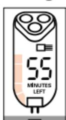
De **vakjes** laten u steeds zien hoeveel lading de oplaadbare batterijen bevatten. (De aanduiding van de energiemeter heeft geen betrekking op de scheerprestaties.)
