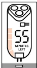
**Medidor de energia.** Indica-lhe que quantidade de **energia** é que as células recarregáveis contêm.
