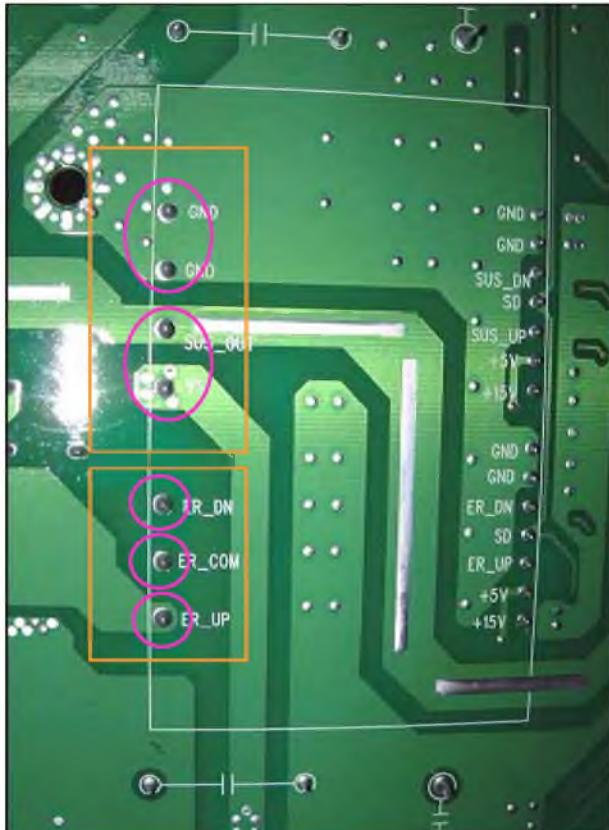
Forward : test 1 GND(+) , Sus-out(-)
