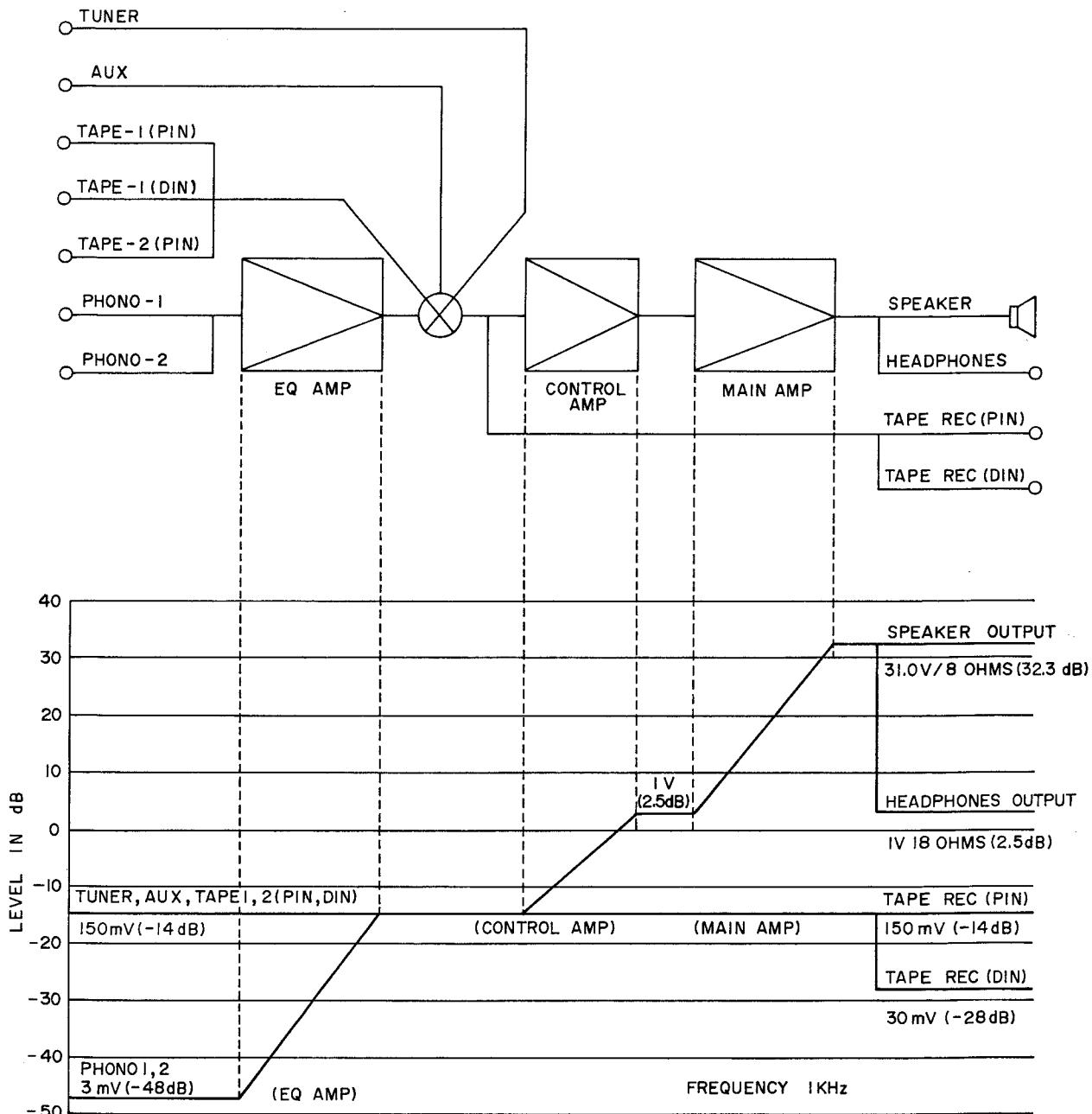
Fig. 13 Level Diagram
