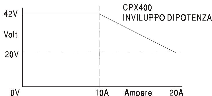
L'involucro di potenza è impostato per dare 42V/10A e 20V/20A sotto tutte le condizioni di carico (ambedue le uscite sotto carico); a tensioni in uscita più basse la potenza in uscita viene ristretta dal limite massimo di corrente di 20A.
