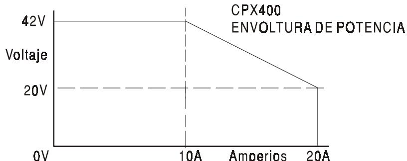
La envoltura de potencia está fijada para producir 42V/10A y 20V/20A bajo toda condición de suministro (con ambas salidas cargadas); para salidas de voltaje inferiores, la potencia de salida está limitada por la corriente máxima de 20A.
