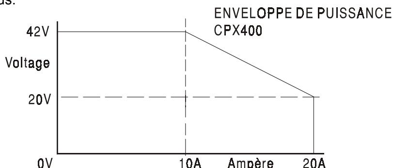
L'enveloppe de puissance est réglée pour donner 42 V/10 A et 20 V/20 A à toutes les conditions d'alimentation (les deux sorties chargées); à de plus basses tensions de sortie, la puissance de sortie est restreinte par le courant de 20 A maximum.
