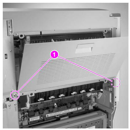
Figure 88. Screws on upper left door
