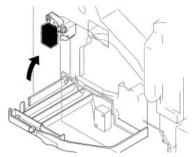
Figure 217. Toner carousel door detection interlock
