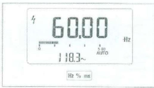
Рисунок 3 14. Типовой вид дисплея при измерениях частоты
