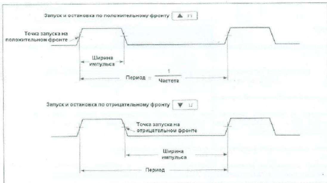
Рисунок 3 17. Измерение ширины импульса
