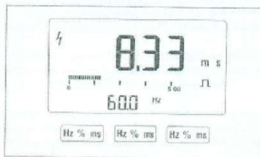
Рисунок 3 18. Типовой дисплей при измерениях ширины импульса
