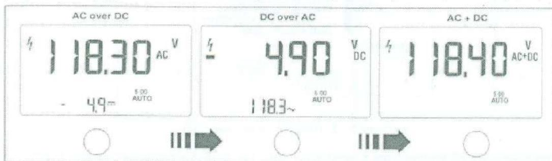
**Рисунок 3 3. Дисплеи с выводом переменной и постоянной составляющих напряжения**
