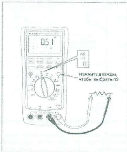
Рисунок 3-7. Измерение проводимости
