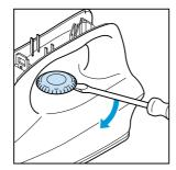
remove **THERM. DIAL 4** remove **SCREW B (4x)**
