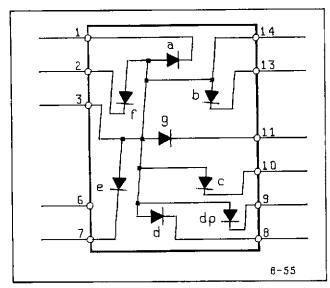
Figure 8-55. Internal Circuit Diagram For A2DS2-DS7 and DS9.
