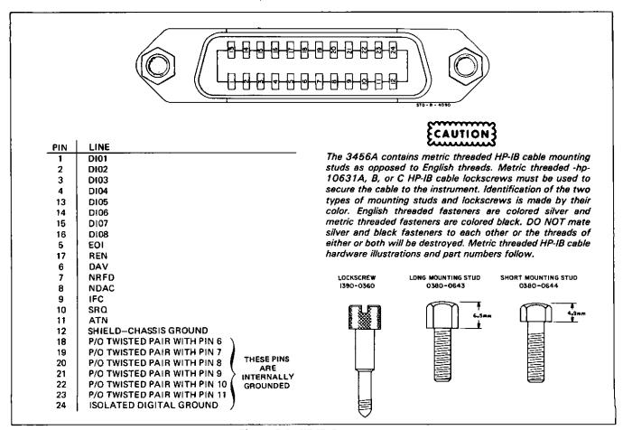
Figure 2-4. HP-IB Connector.
