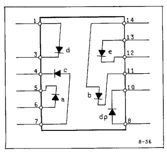
Figure 8-56. Internal Circuit Diagram For A2DS1 and DS8.
