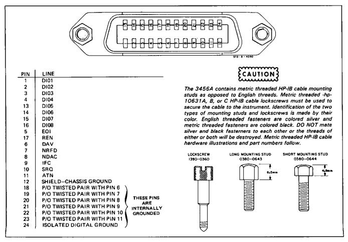
Figure 2-4. HP-IB Connector.
