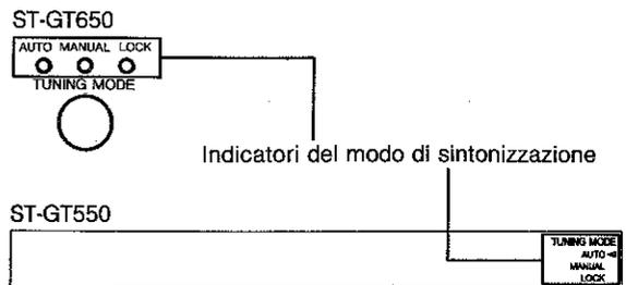
Nel modo "AUTO", la stazione vicina, con frequenza di trasmissione più alta o più bassa, viene sintonizzata automaticamente.
