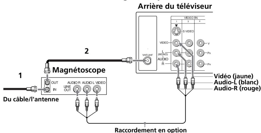
✎ Pour regarder des programmes vidéo depuis le magnétoscope, réglez votre téléviseur sur le canal 3 ou 4 (voir le réglage à l'arrière de votre magnétoscope).
