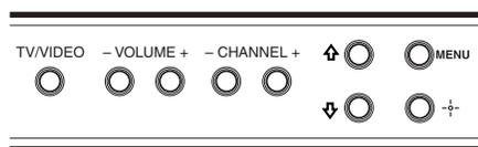
Los controles del panel de audio/video frontal le permiten acceder al menú sin utilizar el control remoto.
