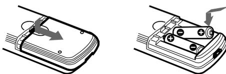
⚠ Dans des conditions d'utilisation normales, les piles durent six mois. Si la télécommande ne fonctionne pas correctement, les piles sont peut-être à plat.
