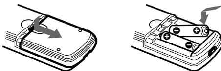
✎ En condiciones de uso normales, las baterías tienen una duración máxima de seis meses. Si el control remoto no funciona correctamente, es posible que las baterías estén gastadas.
