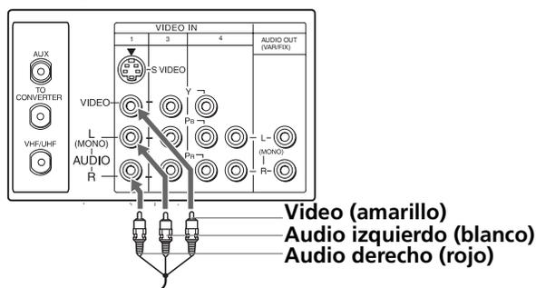
Para obtener una mejor calidad de imagen, utilice S VIDEO en lugar del cable amarillo de video. Como S VIDEO no proporciona sonido, debe mantener conectados los cables de audio.
