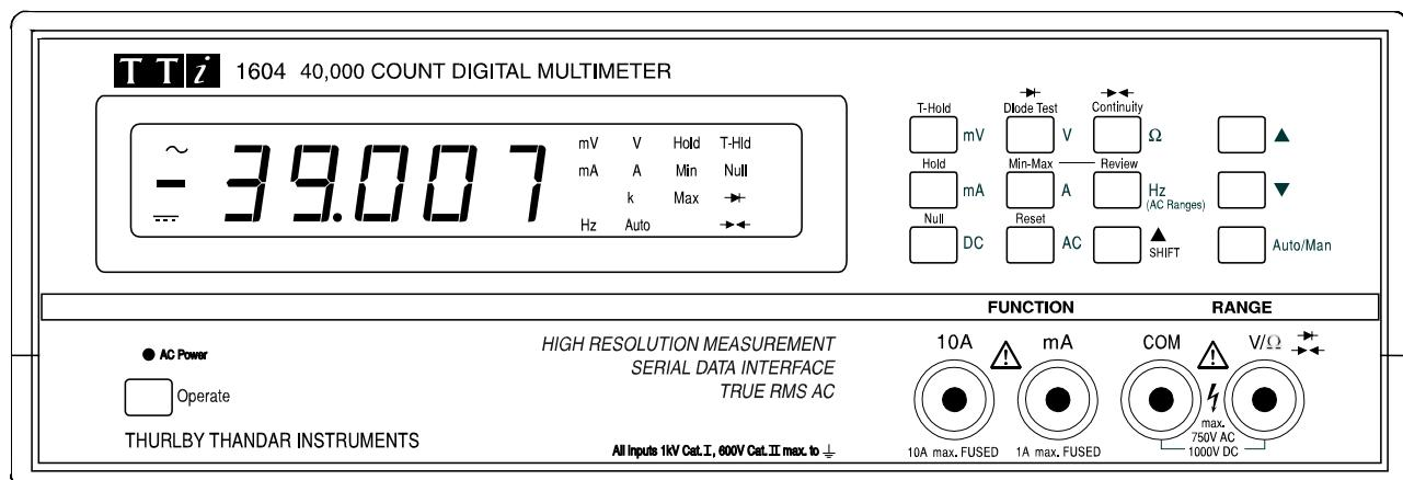
Les fonctions primaires sont sélectionnées en appuyant sur les touches appropriées, par exemple V et DC pour CC Volts; les fonctions primaires sont indiquées à côté de la touche. Pour mettre le multimètre en mode manuel ou automatique appuyer sur la touche Auto/Man ; les flèches peuvent aussi être utilisées; elles changent la zone de mesure et mettent l'appareil en mode manuel.
