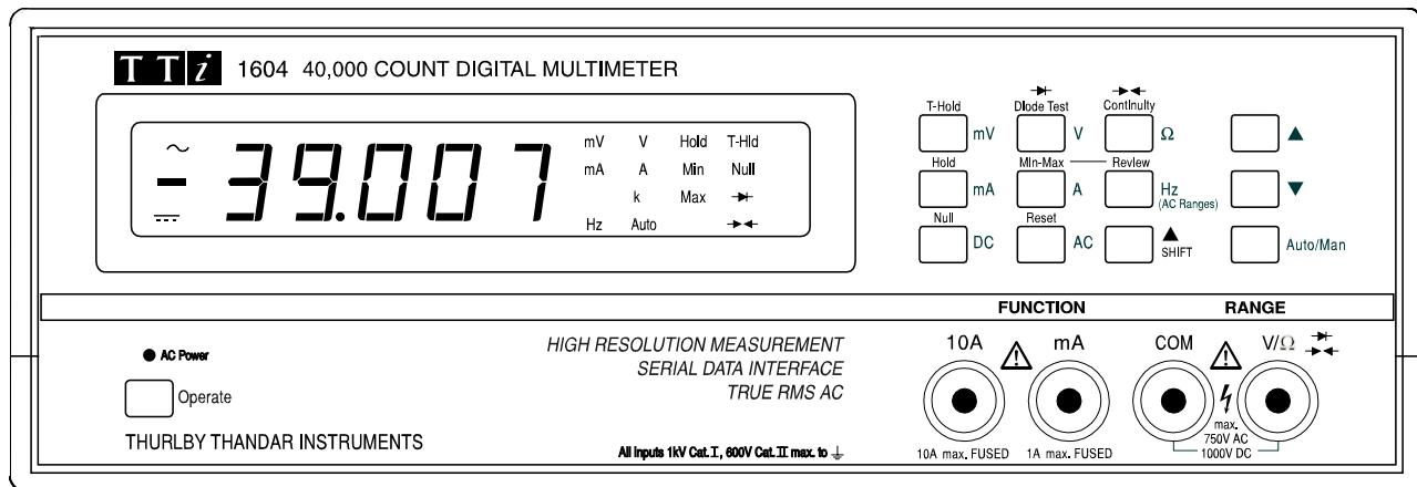
Las funciones principales se seleccionan al pulsar las teclas correspondientes; por ejemplo, V y DC para voltios y CC. La función principal se muestra al lado de la tecla correspondiente. El multímetro pasa del modo automático al manual al pulsar alternadamente la tecla Auto/Man; o, también, mediante las teclas de flecha arriba/abajo que cambian los parámetros y establecen el modo manual para la selección de valores.
