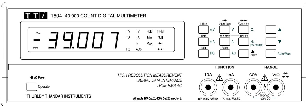
Die Auswahl der Primärfunktion wird direkt gemacht, indem die entsprechenden Tasten gedrückt werden, z.B.: V (Volt) und DC (Gleichstrom) für DC Volt; die Primärfunktion wird neben der Taste angezeigt. Der Meter ist zwischen auto-Bereich und manuell geschaltet und das wechselseitige Benutzen der Tasten mit Pfeil nach unten und Pfeil nach oben verändert den Bereich und stellt auf manuelle Bereichausrichtung.
