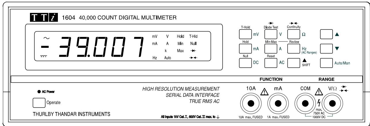
Una selezione delle funzioni primarie viene fatta direttamente premendo le chiavi adatte per es. V e DC per DC Volts; la funzione primaria è visibile accanto alla chiave. Il contatore è attivato tra autorange e manuale con presse alternate della chiave Auto/Man; in alternativa, usando le chiavi con le frecce all'insù e all'ingiù è possibile cambiare il range e determina il ranging manuale.
